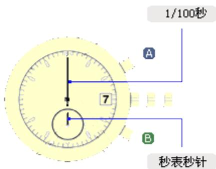
在更换电池以及秒表复位后秒表各针不能回到 0 秒位置上时（受到强烈的震动秒表针可能会出现很少有的指针无法归零情况）请进行下列操作将指针调至 0 位。
