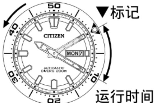
1. 旋转旋转表圈，将▼标记设置到分针的当前位置。
