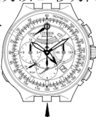
直到电量指示针指向水平 3，请将手表放置在直
